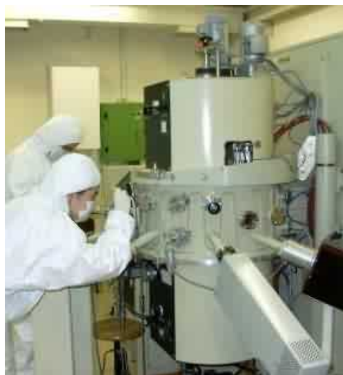
Εικ.3 Σύστημα εναπόθεσης λεπτών υμενίων και επικαλύψεων.
