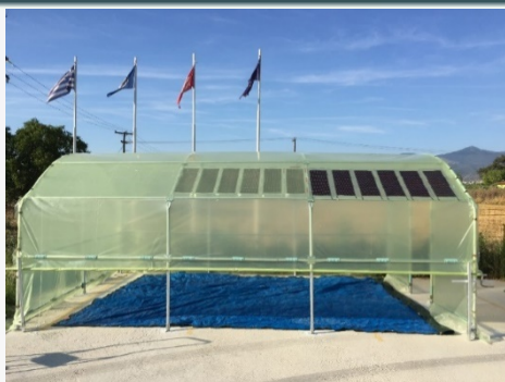
Εικόνα 8. Πειραματικό θερμοκήπιο με εγκατεστημένα OPVs της εταιρείας OET
