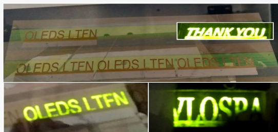
Σχήμα 3: Πλήρως εκτυπωμένες διατάξεις OLED
