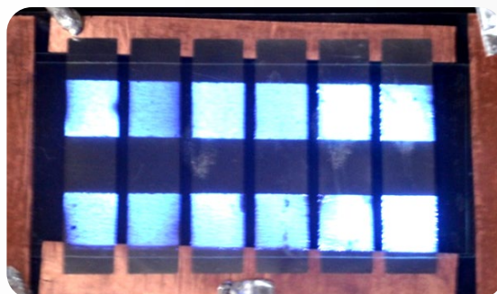
Εικόνα 7: Τυπωμένο OLED 12 cm 2 με θερμικά εξαχνόμενο ηλεκτρόδιο καθόδου (Semi printed)
