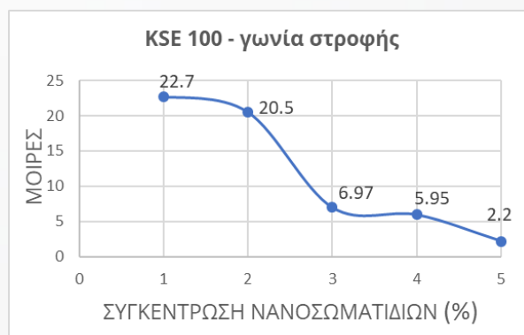
Εικόνα 2: Διάγραμμα συγκεντρώσεων νανοσωματιδίων στα διαλύματα σε συνάρτηση με τη γωνία
