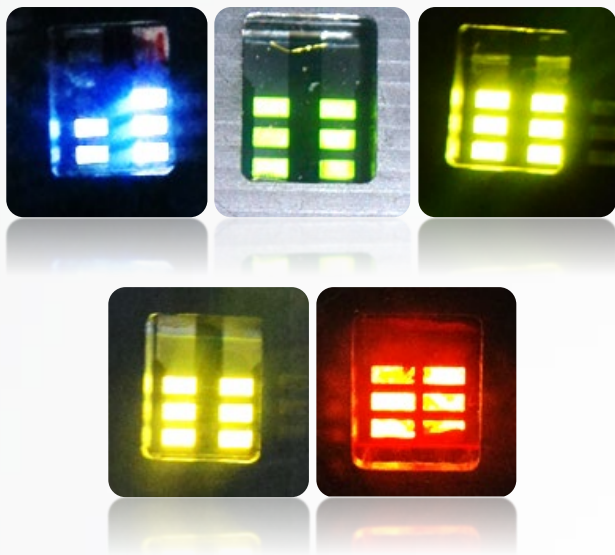
Εικόνα 4: Πρότυπες άκαμπτες OLED διατάξεις όλων των χρωμάτων του RGB
