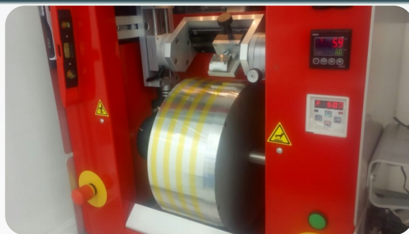
Εικόνα 6: Mini Roll Coater στις εγκατάστασης της εταιρείας OET. Πειραματική διάταξη ανάπτυξης λεπτών υμενίων με την τεχνική Slot die.
