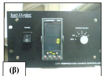
Εικόνα 2. (α) Θάλαμος θερμικής εξάχνωσης, (β) Controller για την ρύθμιση των παραμέτρων ανάπτυξης
