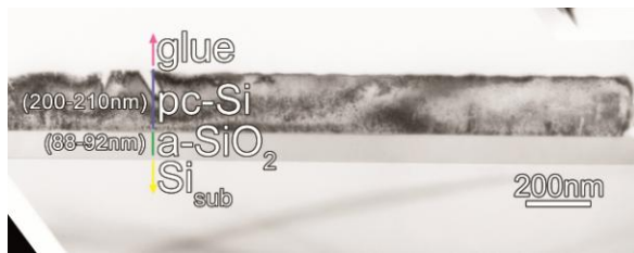
Εικόνα 1. Δείγμα D2001. Εικόνα φωτεινού πεδίου TEM όπου φαίνεται η ποιότητα του κρυστάλλου.
