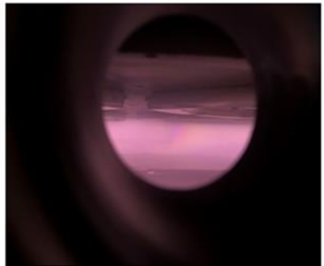
Εικόνα 2: Το πλάσμα στην στοιχειομετρική του κατάσταση ( TiN_x , με x=1 ) εκπέμπει ανοιχτό μωβ χρώμα
