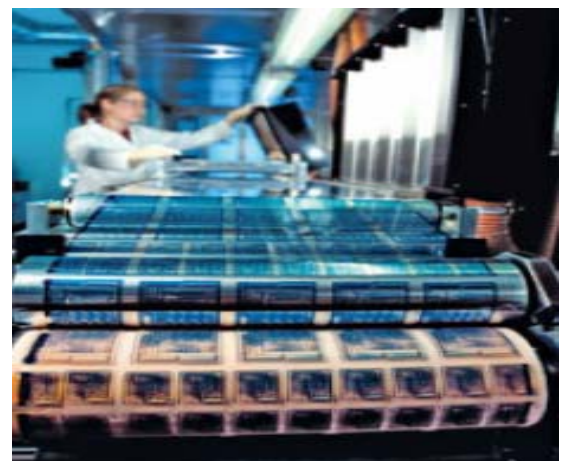
Σχ. 2β. Large scale r2r ανάπτυξη διατάξεων Organic Electronics (Πηγή:Merck)
