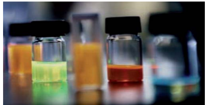
Σχ. 2α. Οργανικά ημιαγωγικά υλικά σε μορφή διαλύματος, έτοιμα προς χρήση
